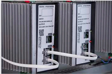
درايو اختصاصی به ازای هر بوزریشن با قابلیت اتصال به اینترنت special motor driver for each motor
