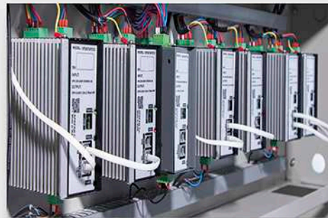
درايو اختصاصی به ازای هر یوزیشن با قابلیت اتصال به اینترنت special motor driver for each motor
