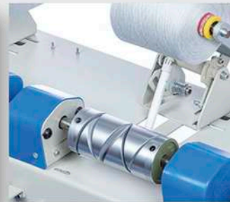
تنظیم تراکم دوک Bobin density setting unit
