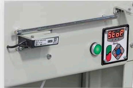
یونیت کنترل مجزا و سنسور قطع کن به ازای هر پوزیشن Digital speed control unit
