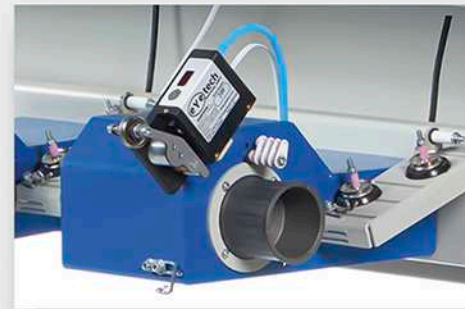
مکانیزم فیدر Yarn tension and feeding unit
