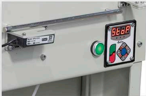
پنل کنترل و سنسور قطع کن به ازای هر یوزیشن Digital speed control unit
