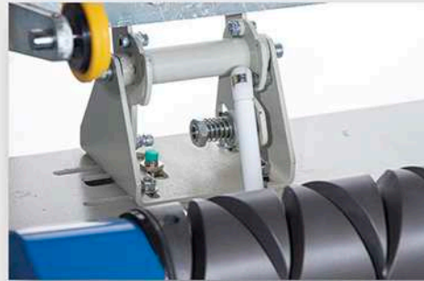
مکانیزم دسته تنظیم تراکم مکانیکی و سنسور سائز دوک Bobin density seting unit and size sensor
