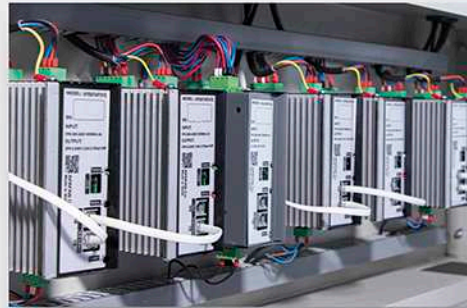
درایو اختصاصی به ازای هر پوزیشن با قابلیت اتصال به اینترنت special motor driver for each motor
