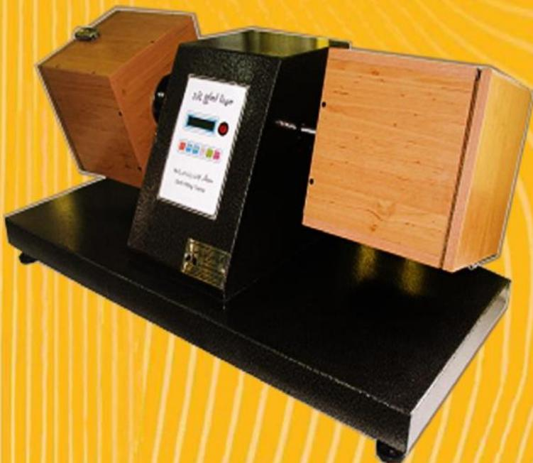
دستگاه فوق به منظور تعیین میزان پرزدار شدن سطح انواع پارچه در اثر تماس با محیط و لذا طبقه بنده آنها به منظور تعیین پوشش ایده ال بکار می رود.
