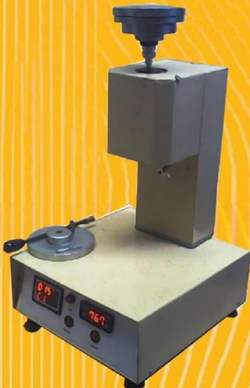
کاربرد و عملکرد دستگاه: از این دستگاه برای تعیین گرید مواد پلاستیکی، تعیین فرآیند مناسب برای تولید آنها (برای مثال اکستروژن و تزریقی) و همچنین میزان تغییر خواص مواد بعد از فرآیند تولید استفاده می‌گردد.
