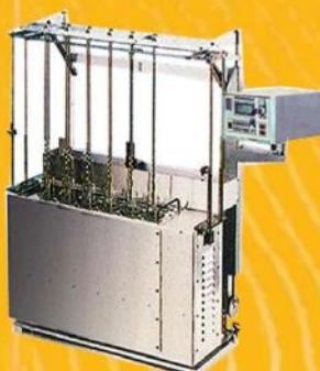
دستگاه نمونه رنگ کن آزمایشگاهی اتمسفریک
