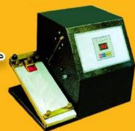
دستگاه اندازه گیری ثبات سایشی رنگ پارچه
